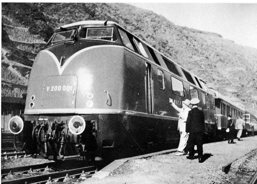
Bild 12: Dieselhydraulische Lokomotive Baureihe V200 der Deutschen Bundesbahn, 1954.
