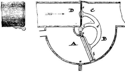
Bild 4: Schnitt durch eine Verschlussklappe, 1841 (Samuda 1841, S. 5).
