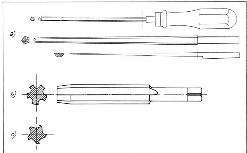
Bild 5: Reibahlen (a aus: Prechtl, J. J.: *Technologische Encyklopaedie*, Bd. 11, Stuttgart 1841, Tf. 242, Fig. 2, 5–6; b Skizze d. V. nach: *Der Maschinenbauer* 24 [1889], Anzeige der Fa. Gebr. Werner, Lennepl).
