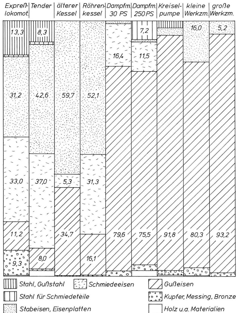
Bild 1: Materialzusammensetzung von Maschinen und Apparaten um 1880 (Graphik des Verfassers nach: Leyk, J. van: Die Produktionskosten der Maschinenbauindustrie in Deutschland, England und Frankreich, in: Stahl u. Eisen [1884], S. 472–473).
