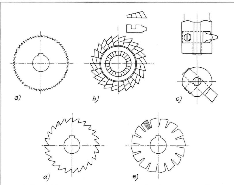
Bild 4: Entwicklung von Zahnform und -größe bei Fräsern im 19. Jh. (a, d, e aus: Zeitschrift für Werkzeuge und Werkzeugmaschinen [1910/11], S. 155, Fig. 1–3; b Skizze d. V. nach: Prechtl, J. J.: Technologische Encyclopaedie, Supplemente, Bd. 3, Stuttgart 1861, Tf. 76, Fig. 3–4; c Skizze d. V. nach: Der Maschinenbauer 22 [1887], S. 252, Fig. 8).
