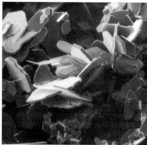
b) Sechseckige Einkristallplättchen aus Silizium-Karbid (220 ×).
