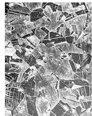
Bild 2b: Mikrogefüge desselben Armreif. Das Gefüge zeigt, dass die Zinnbronze nach dem Guss geschmiedet und anschliessend nochmals auf mindestens 500 °C erhitzt worden ist, um die endgültige Form zu erreichen. Hierdurch wurde eine Rekristallisation des ursprünglichen Gussgefüges im festen Zustand hervorgerufen. Zu erkennen sind kleine Einschlüsse von Kupfersulfid, die auf eine Herstellung der Bronze aus sulfidischen Erzen deutet. Massstab: 0,1 mm. Auflicht, geätzt mit Eisenchlorid.
