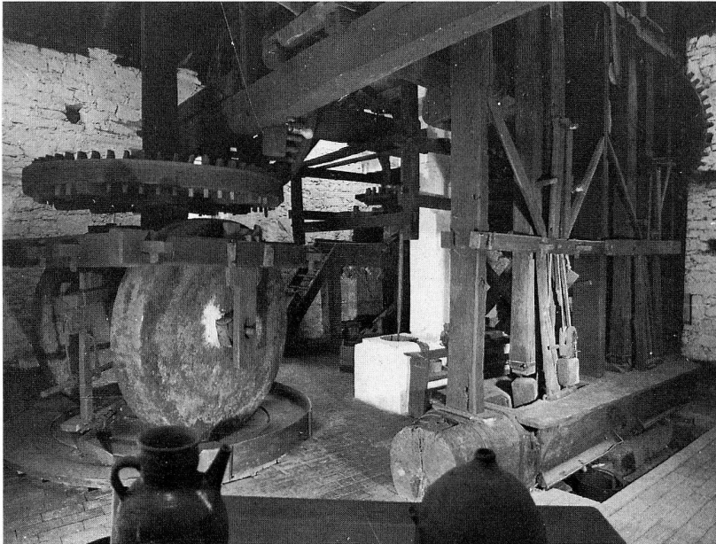
Bild 3: Ölmühle in Lemgo-Brake. Bei dieser Mühlen-technik war nur der Lagerzapfen der Welle aus Eisen. Diese «hölzerne Maschine» produzierte bis 1925.
