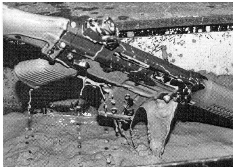
Bild 13: Sturmgewehr 90 im Schlammtest.
