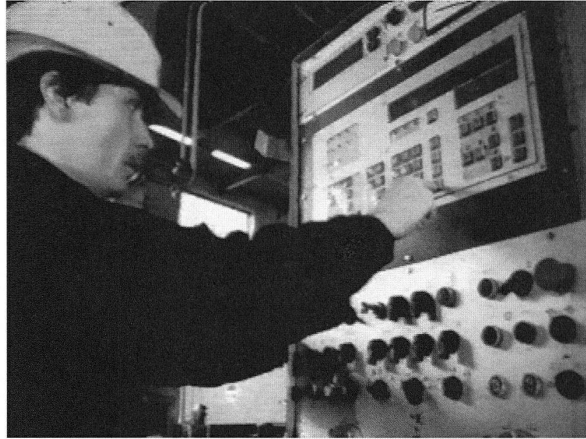
Standbild aus dem Böhler-Film «Gewusst Wie» (1975). Ein Arbeiter der mechanischen Werkstätte an der Steuereinheit einer CNC-Fräsmaschine.
