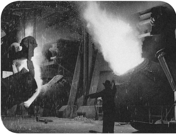
Die Stahlindustrie bot den Industriefilmern besonders spektakuläre Aufnahmen, wie hier im Thomasstahlwerk der August Thyssen-Hütte AG, wo ein blasender Konverter (rechts) zu sehen ist, während der zweite Konverter mit Roheisen gefüllt wird, Mitte der 1950er-Jahre (Fotograf: Herbert List, Quelle: ThyssenKrupp Konzernarchiv, Duisburg).
