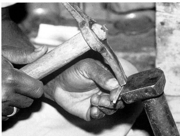
Abb. 35: Absetzen des Materials zwischen den gemeisselten Rillen.
