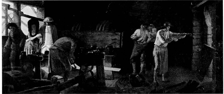
Bild 12: Zweigerüstiges Stabeisenwalzwerk mit Wasserantrieb: ein Walzgerüst, ein Schneidgerüst; Lüttich, um 1734.
