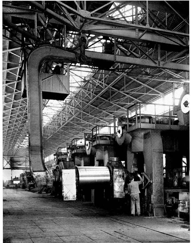
Wechsel der Stützenwalzen der 6-gerüstigen Fertigstrasse, um 1937.
