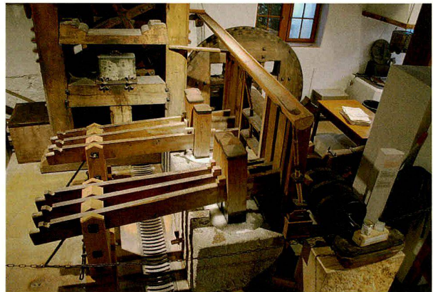
Lumpenstampfwerk in der Basler Papiermühle.
