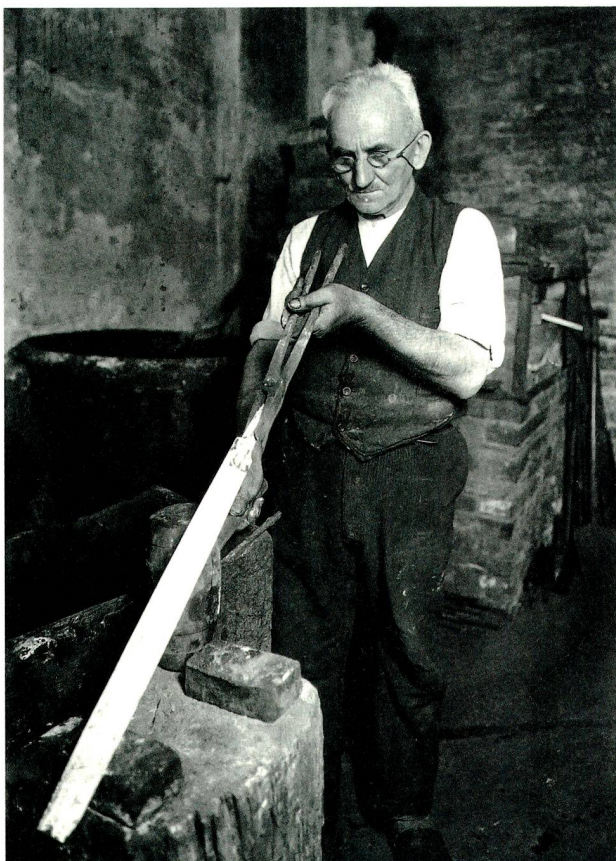
1 Willy Römer, Feilenhauer beim Richten der glühenden Feile vor dem Abkühlen im Härtebad, Berlin 1931.
