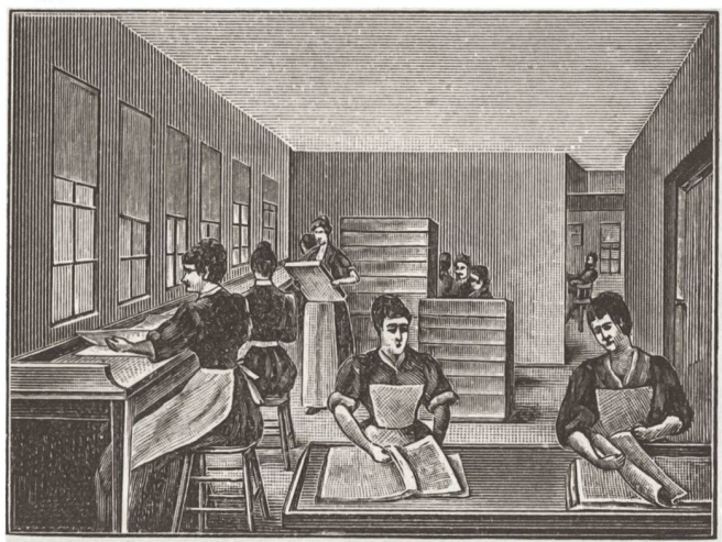
5 Schritte bei der Herstellung von Albumin-Kopierpapier für die Fotografie: Schlagen des Albumins zu Schaum, Tränken des Kopierpapiers mit flüssigem Albumin und Aufhängen zur Trocknung, Satinieren des Albuminpapiers, d.h. Pressen im Kalandr, um eine geschlossene, glänzende, glatte Papieroberfläche zu erhalten, und schliesslich Sortieren und Verpacken des handelsfertigen Papiers.
