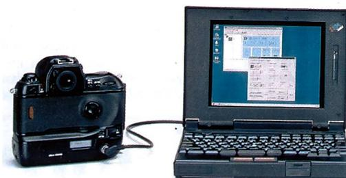
So erweitert die Nikon F5-Software AC-1WE/AC-1 ME u.a. die Zahl der kameraeigenen 24 Individualprogramme um weitere 17 Konfigurationsoptionen. Möglich wird auch die Koppelung von zwei F5-Kameras, die bei PC-Steuerung bis 16 Bilder in der Sekunde schaffen, und dank dem raschen Zugriff auf Aufnahme- und Bilddaten wird die Suche, Ausgabe und Archivierung von Daten einfacher denn je. Um die F5 auf einem PC unter
