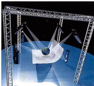
Hier das Prinzip dieses neuartigen Lichtsystems: Kier nahm sechs Spezi- alscheinwerfer der Firma Martin Professional A/S, wie sie in Theatern und bei grossen Live-Konzerten verwendet werden. Diese enthalten je eine spezielle MSR-Lampe mit 1200 Watt Leistung, sind in ihrer Lichtleistung, Farbe und Lichtkegel stufenlos variierbar und lassen sich aus einem einfachen PC steuern. Zudem können verschiedenste Farb- und Effektfiler in
