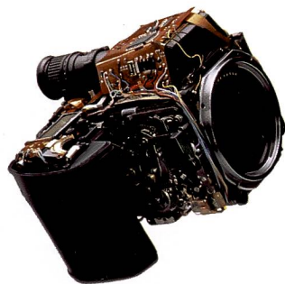
Die Elektronik sowie die wichtigsten mechanischen Teile sind um das Aluminium-Druckgussgehäuse herum angeordnet und werden von einer glasfaserverstärkten Polykarbonathülle geschützt.
