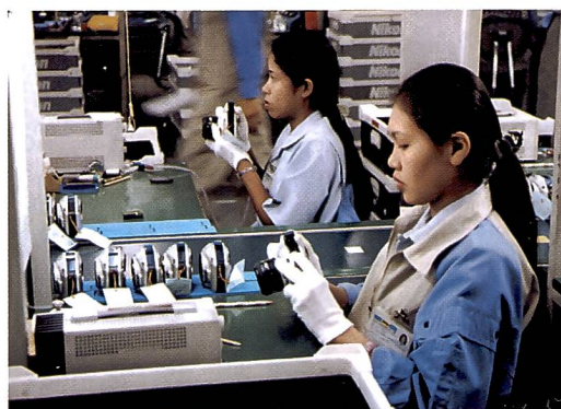
Eine Pronea S besteht aus rund 400 Einzelteilen, die in Baugruppen vormontiert werden und dann in die Montageabteilung kommen. Flinke Hände und höchste Konzentration sind hier gefragt.
