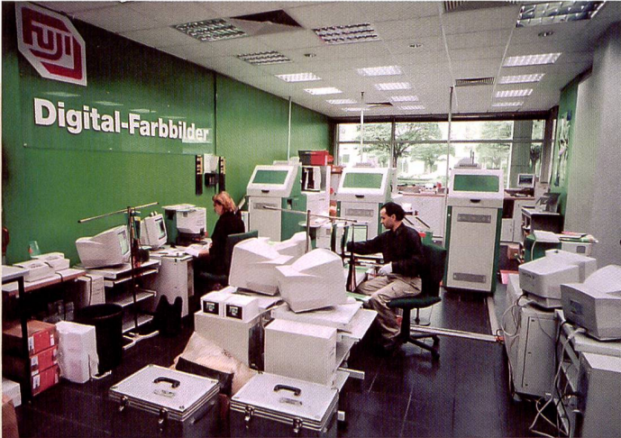
Blick hinter die Kulisse: Im Laborraum sind vier Arbeitsstationen, auf denen die entwickelten Filme eingescannt, die Daten ans Netzwerk gesandt und die CDs gebrannt werden. Im Hintergrund sind die drei Fuji Frontier 1000 zu sehen.
