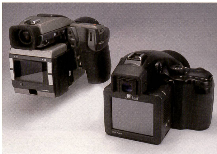
Das digitale Grossformat ist Realität: 33 und 39 Megapixel weisen Leaf Aptus 75 und Phase One P45 auf. Doch die beiden Rückteile unterscheiden sich nicht nur punkto Auflösung, sondern auch durch die Bedienung und die Architektur des Sensors. Beim Resultat überzeugen sie beide.
