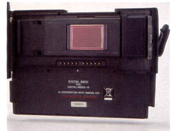
Alles in der Rückwand: der Sensor kommt genau in der Bildebene der Kamera zu liegen.
