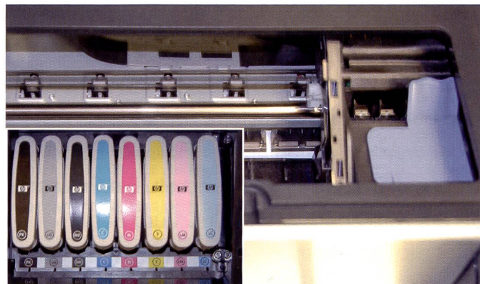
Vier Druckköpfe mit 8448 Düsen bringen die acht verschiedenen Farben zu Papier.
