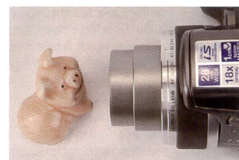
Im Super Makro Modus gelingen mit der Olympus SP-550 UZ Aufnahmen aus einer Distanz von lediglich einem Zentimeter.
