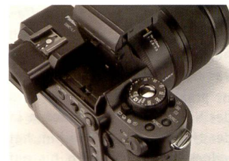
Üppiges Einstellrad für die Festlegung der Verschlusszeit bei der Panasonic Lumix L1.
