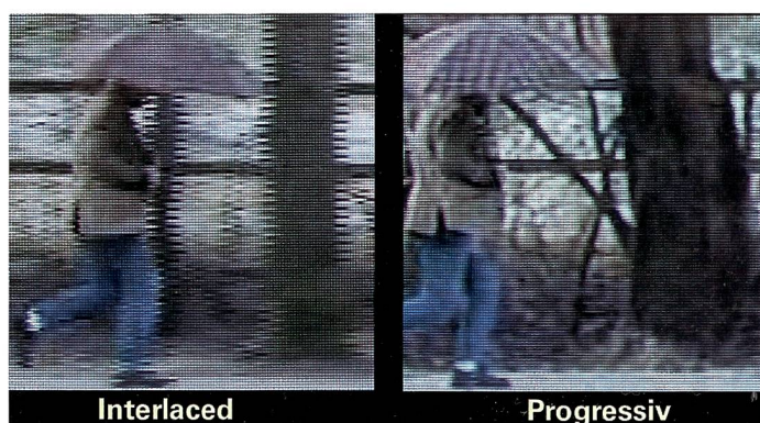
Links das Hauptproblem des Interlaced-Verfahrens: Bei bewegten Bildern passen die beiden Halbbilder nicht zusammen. Das ergibt Unschärfen, die beim Progressiv-Verfahren (rechts) nicht auftreten.
