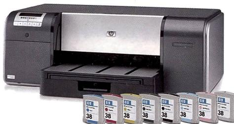
arbeitet mit pigmentierter Tinte in acht einzeln austauschbaren Farbpatronen (HPVivera). Er bietet eine maximale Auflösung von 4800 x 1200 dpi und kommt mit einer Vielzahl von Spezialpapieren von 80 bis 800 g/m<sup>2</sup> bis zu einer Dicke von 1,5 mm zurecht – unter anderem auch mit den HP Druckmedien Aquarellpapier und Künstlerleinwand.
