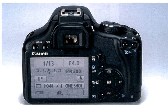
Die Rückseite der Canon EOS 450D wird dominiert vom grossen und hellen drei Zoll Display. Das führt dazu, dass die Verteilung der Knöpfe etwas unordentlich erscheint. Dafür lässt sich fast alles direkt anwählen und muss nicht über das Menü eingestellt werden.
