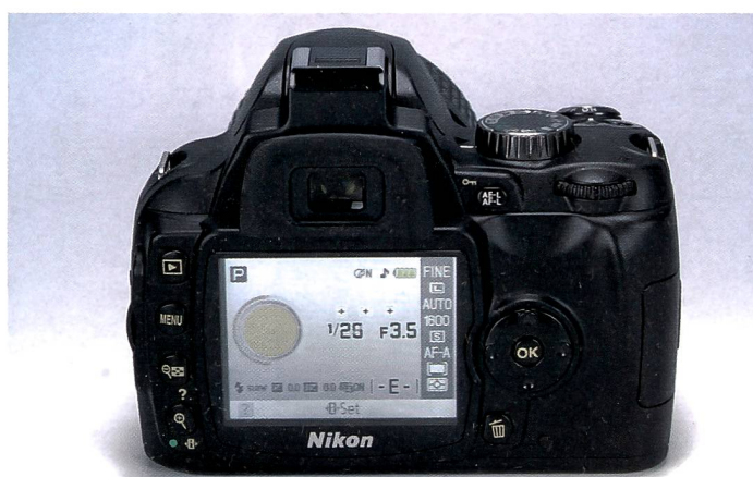
Die Rückseite der Nikon D60 wirkt einiges aufgeräumter. Dem Einsteiger erleichtern viele Automaten das Leben, Weissabgleich oder ISO-Zahl können aber nicht direkt angewählt werden. Schön aber, die grafische Darstellung der Linse im Display, schon von der Nikon D40X bekannt.
