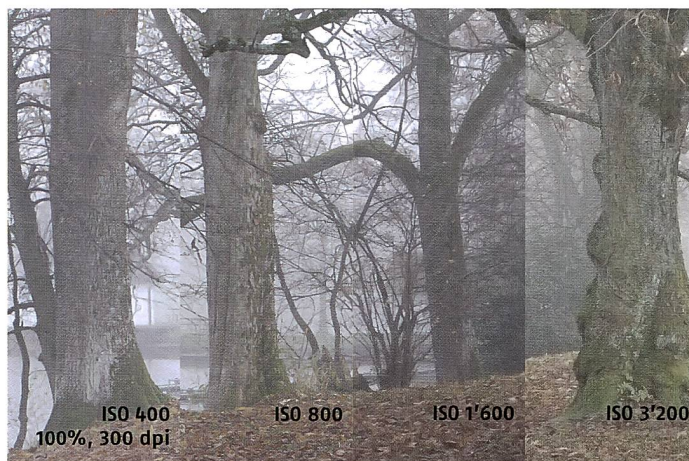
Die Panasonic Lumix G1 zeigt nur ein geringes Rauschen bei hohen ISO-Zahlen. Der grosse Sensor sorgt dafür, dass A4-Drucke bis 1'600 bedenkenlos sind. Das Rauschen bei 3'200 hat eine fast kornartige Wirkung.
