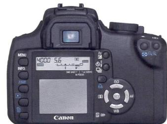
Disposition habituelle des éléments de commande sur le boîtier.
