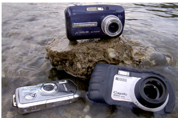
Alors que l'Olympus mju 800 n'est protégé «que» contre les éclaboussures d'eau, le Pentax WR et le Ricoh Caplio 400 G sont étanches jusqu'à 1,5 mètre de profondeur. Un boîtier spécial est recommandé au-delà.
