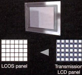
Un projecteur de type LCOS produit des images irréprochables, de haute résolution et garantit des projections vidéo parfaitement fluides et nettes. Chaque composante du signal RVB traitée dans le système optique de séparation et de recombinaison des couleurs dispose de son propre composant LCOS, assurant une image optimale, sans effet arc-en-ciel.
