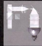
La composante horizontale de la lumière est focalisée parallèlement au système optique de séparation des couleurs, permettant un fort contraste.
