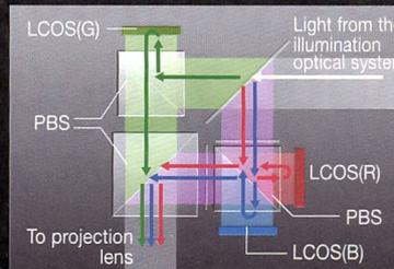
Une technologie exclusive Canon qui s'applique au PBS (Polarisation Beam Splitter : répartiteur de polarisation) produit de superbes images, avec une fidélité des couleurs optimale.
