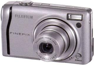
Avec le Finepix F40fd, Fujifilm élargit sa gamme d'appareils possédant la fonction Détection des visages. Celle-ci est également disponible sur les modèles F31fd et S6500fd. Le F40fd, qui est dès maintenant disponible dans le commerce, se distingue par sa finesse. Il offre un capteur Super CCD de 8,3 millions de pixels, un zoom optique 3x et un écran de 2,5 pouces. Le flash «intelligent» et la sensibilité maximale du CCD dopée à 2000 ISO garantis-
