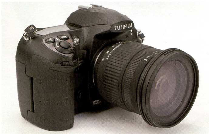
Le Fujifilm Finepix S5 Pro intègre le Super CCD exclusif de sixième génération, prometteur d'une plage dynamique étendue.
