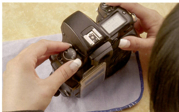
En fonction du modèle d'appareil, il est possible de sélectionner la fonction Nettoyage du capteur dans le menu ou à l'aide d'un sélecteur externe. Le miroir doit être relevé en appuyant légèrement sur le déclencheur, et l'obturateur ouvert, sans que le capteur soit activé.
