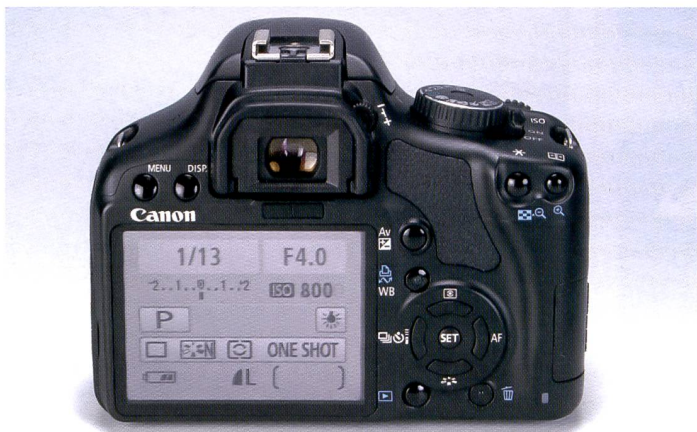
La face arrière du Canon EOS 450D est dominée par le grand écran lumineux de trois pouces. Du coup, la répartition des boutons semble quelque peu désordonnée. Mais le grand avantage, c'est que tout est réglable directement sans passer par le menu.
