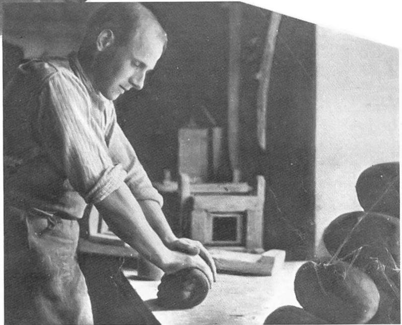
Eine Arbeit, auf die der Ofenbauer besonders Wert legt, denn sie muß mit viel Liebe und Genauigkeit gemacht werden: das nochmalige Kneten der einzelnen, mit einer primitiven Maschine abgeteilten Stücke für die Kacheln. Es ist durchaus nicht so einfach, wie es aussieht, denn es darf keine Luft in der Masse bleiben, sonst gibt es später poröse Stellen.
