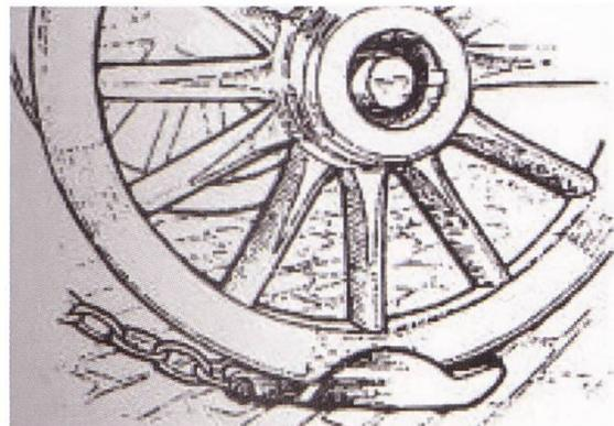
Abbildung 98: Zeichnung eines am Rad befestigten Brems-Schuhs
