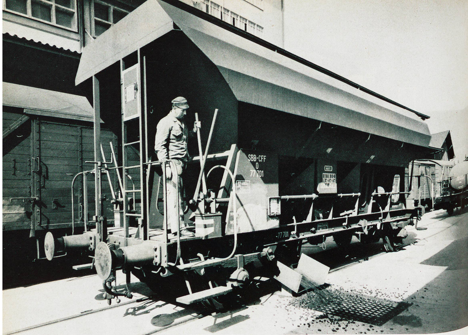
Beim neuen Selbstentladewagen für Kohle- und Kokstransporte kann das Ladegut direkt in eine Schüttgrube entladen werden
