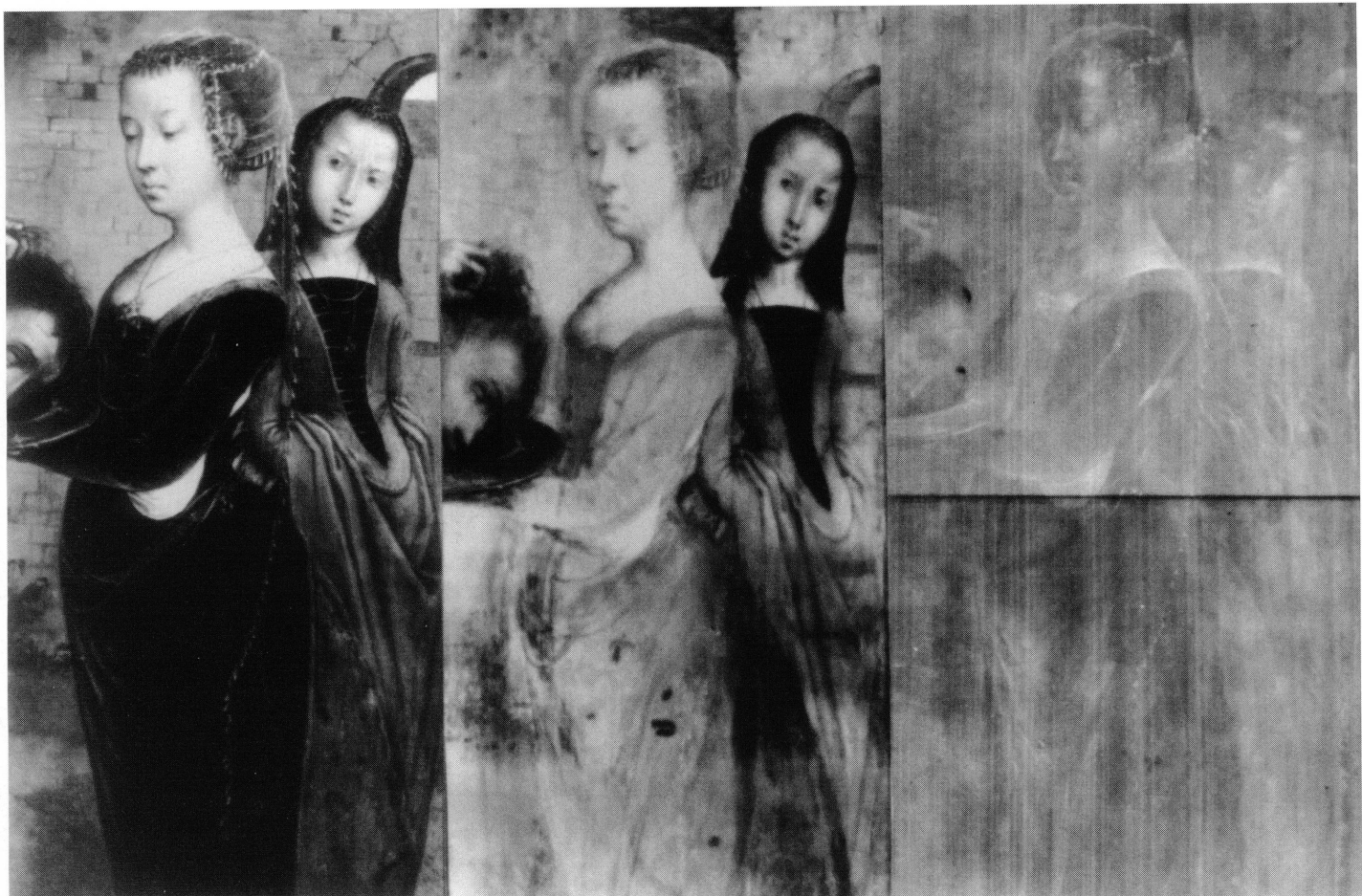
10 a.b.c. La Décollation , Juan de Flandes, détail du personnage de Salomé en lumière normale, IR (tube vidicon Hamamatsu n° 2606-06, logiciel de traitement et assemblage d'images infrarouges Mosart, Amparo Corporation, Santa Fe, USA), et radiographie (48 kV, 2 min, 2,5 mA, films Structurix D4, Agfa-Gevaert, 30 x 40 cm).
