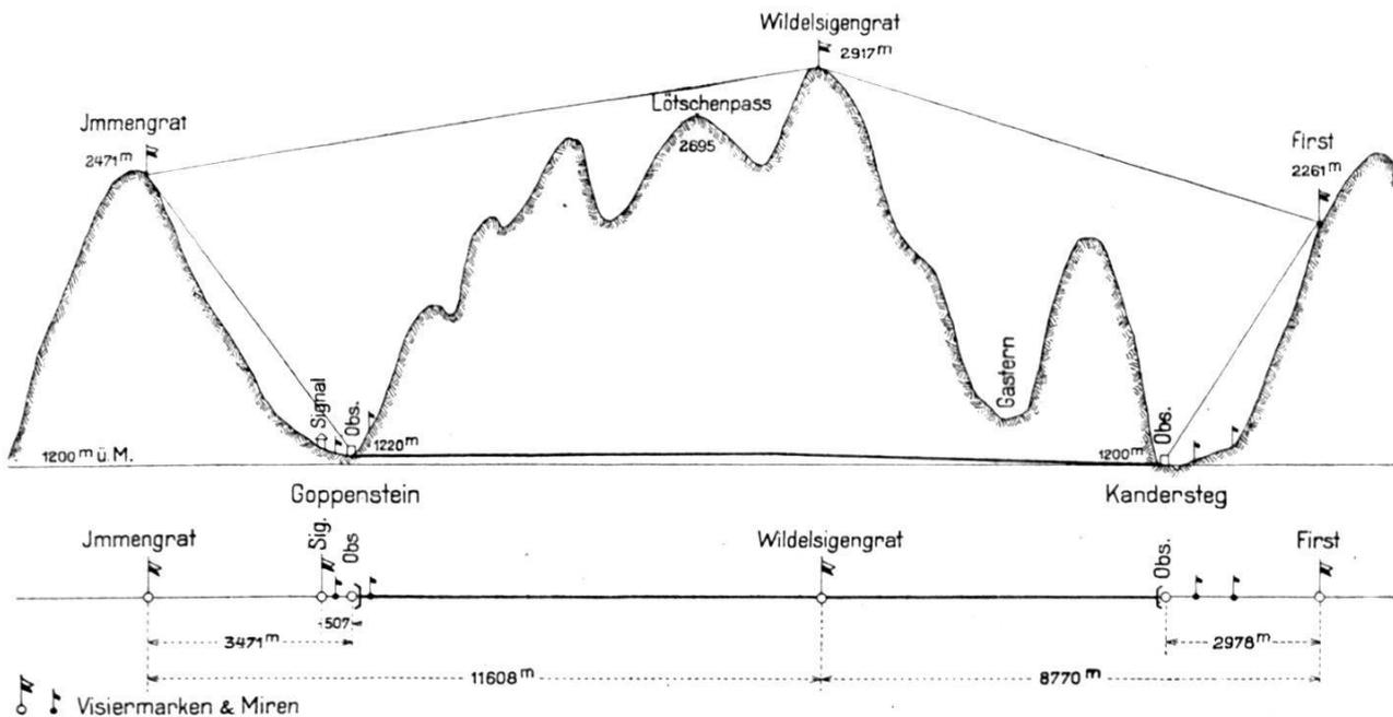
Längensprofil und Grundriss der Lötschbergtunnelabsteckung.
