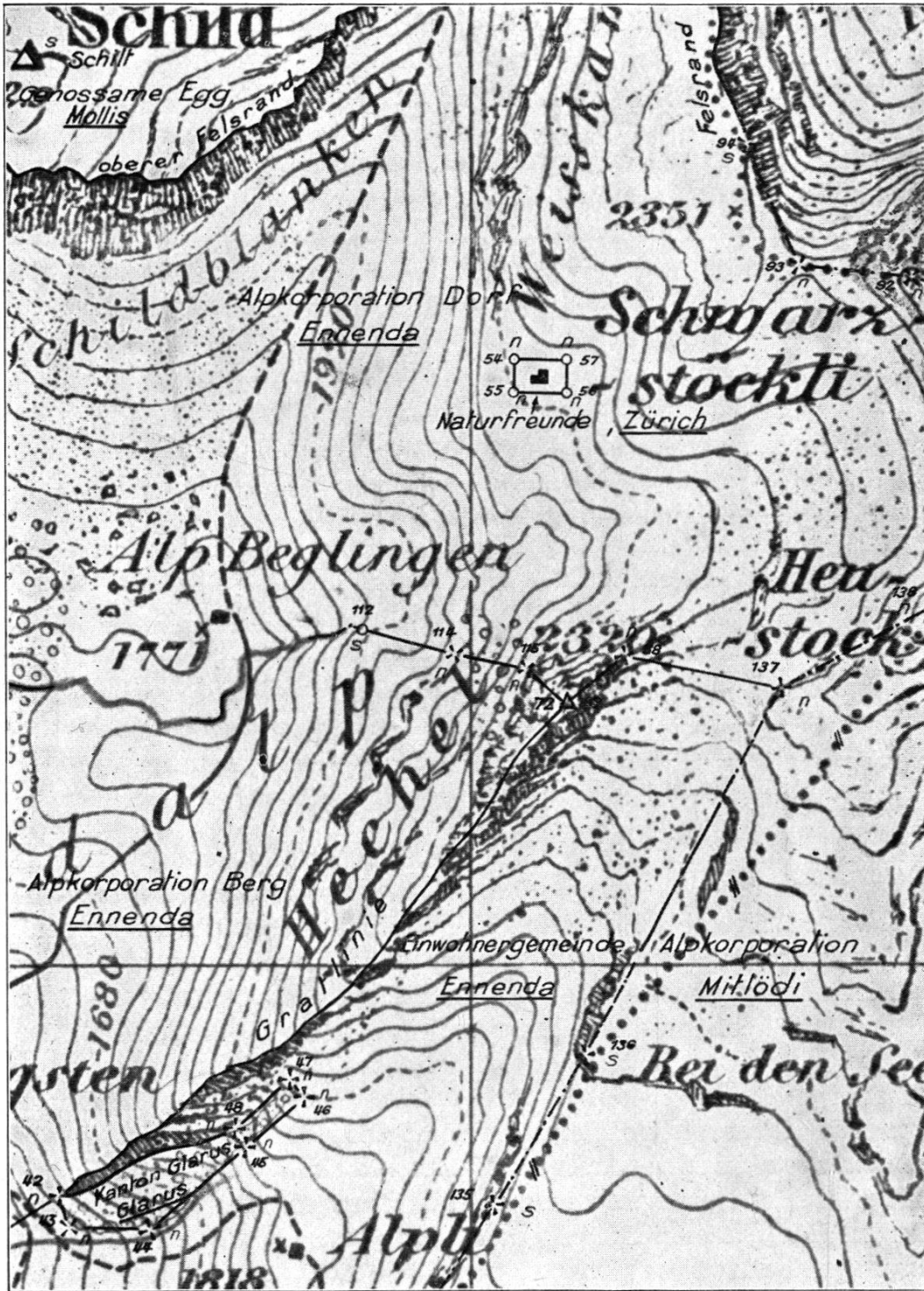
Abb. 1. Vermarkungsskizze mit den Signalisierungseintragungen. (Einfarbige Wiedergabe eines Ausschnittes.)
