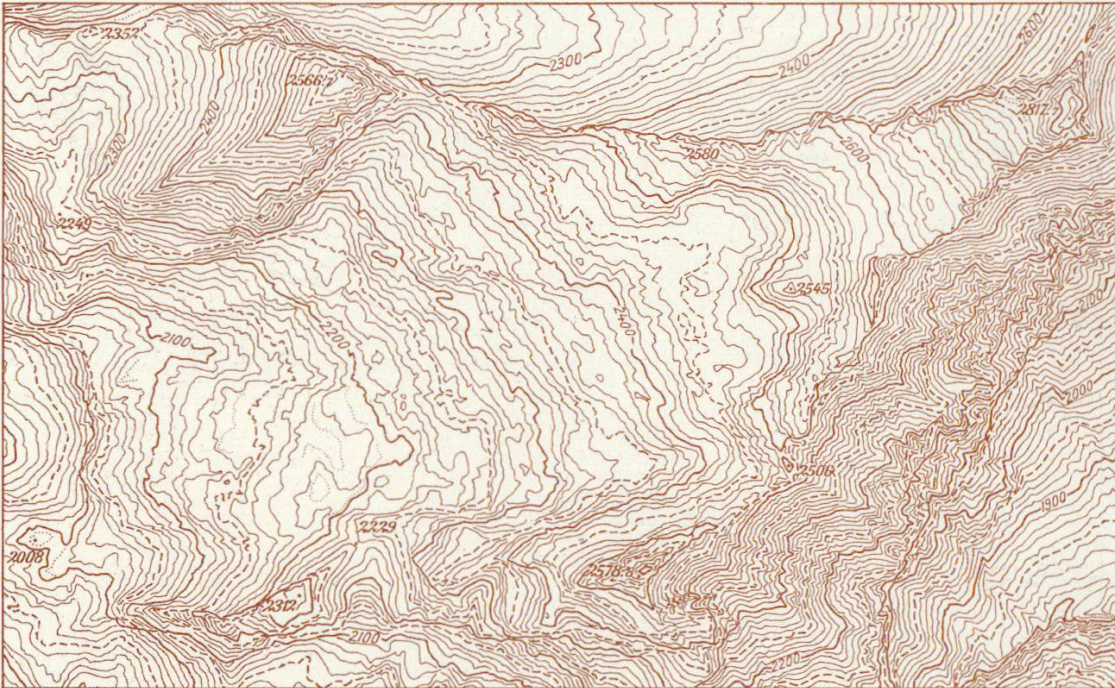
Abb. 23. Verlorrenberg; stereoautogrammetrisch gewonnenes Kurvenbild;
