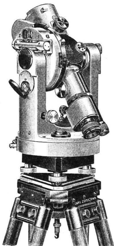
Optischer Präzisionsdistanzmesser für Polygonierung und Stückvermessung
