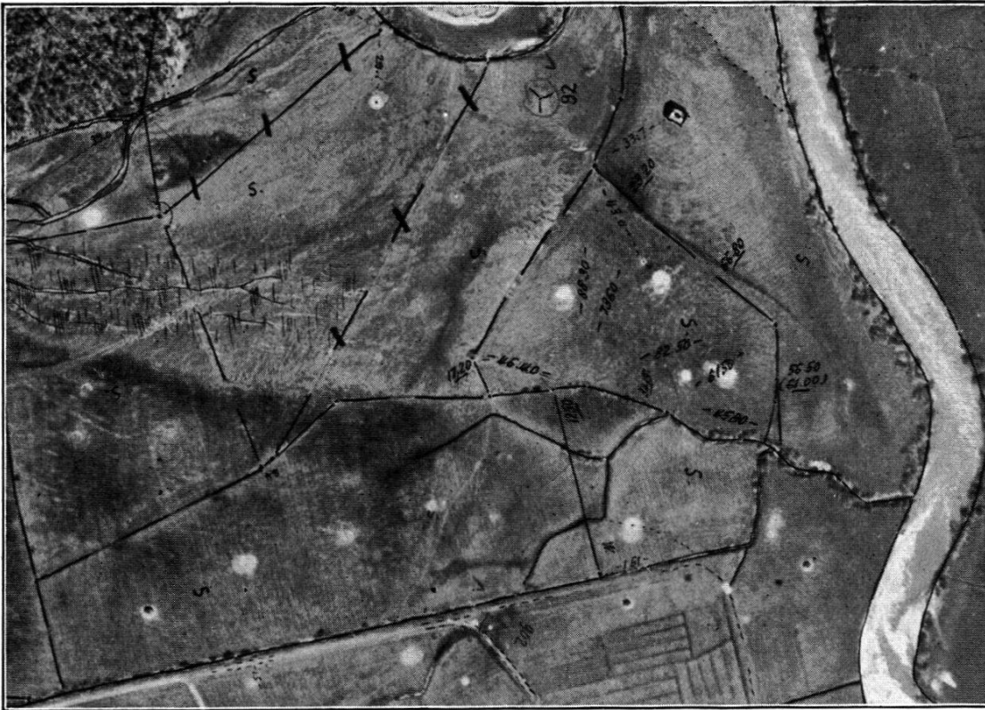
Fig. 1. Ausschnitt aus einem Identifizierungskroki Sihlseevermessung; einfarbige Reproduktion; Original im Maßstab ca. 1 : 2000
