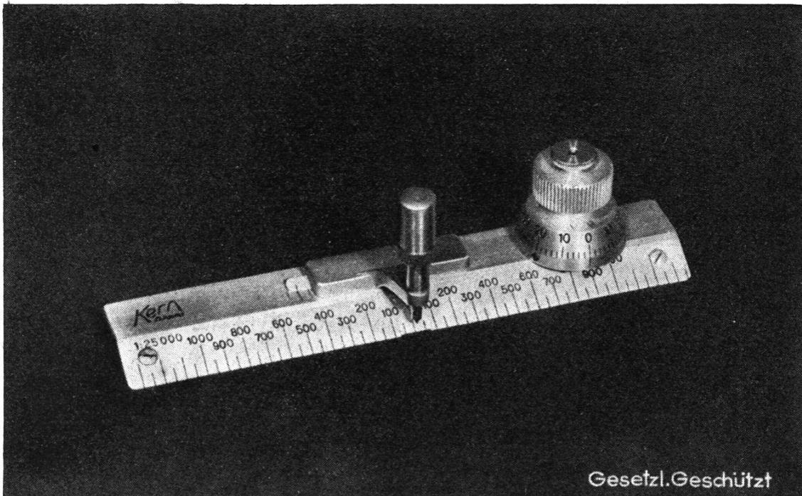
halten ist, so kann praktisch der Übertragungsmechanismus als fehlerfrei angesehen werden. Es verbleibt also in der Hauptsache nur der oben erwähnte Fehler der Indexeinstellung von 0,025 bis 0,03 mm für die Gesamtfunktion eines Distanzauftrages, d. h. ca.  $\frac{1}{3}$  der bis anhin getätigten Meßtisch-Auftragsmethoden.
