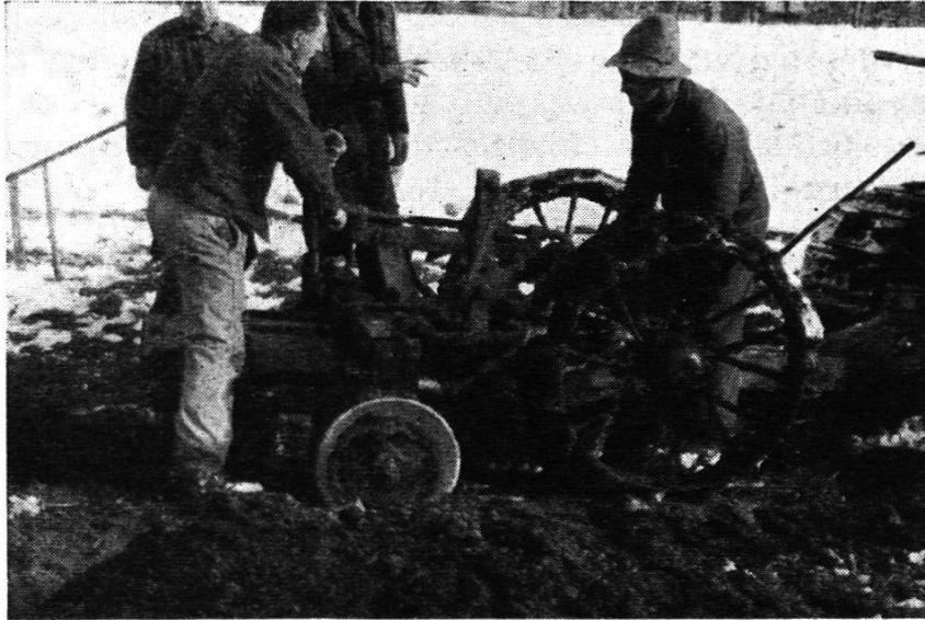
Abb. 3. Der Maulwurfspflug steht rittlings über der Kupplungsgrube
