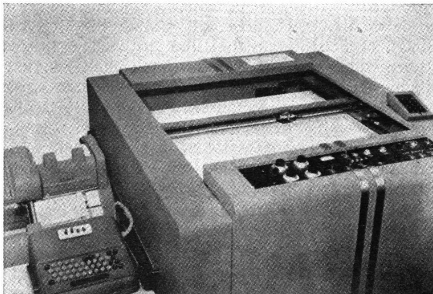
Abb. 9. «Automatic Line Plotter» zum Kartieren von Querprofilen aus Lochkarten- oder Lochstreifenangaben
