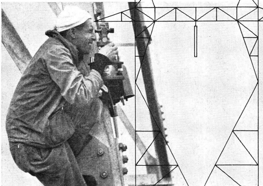
Selbst unter schwierigen Arbeitsbedingungen leistet der kleine, handliche Bussolen-Theodolit Wild TO sehr gute Dienste. Sein Horizontalkreis kann je nach Bedarf am Dreifuß festgeklemmt oder mit dem am Kreis befestigten Magneten nach Norden orientiert werden. Eine ausführliche Beschreibung finden Sie im Prospekt Th 125.
