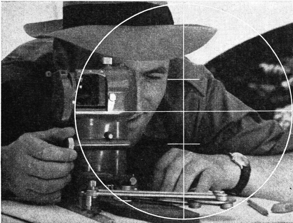
**RK** — Modernste Messtischrüstung für topographische Arbeiten / stabile Tischaufstellung durch eingebauten Messtischkopf mit Kugelgelenk / neuartige Kippregel mit bequemem, festem Okulareinblick / aufrechtes Fernrohrbild / selbstreduzierende Distanzmessrichtung / direkte Ablesung der Höhendifferenz / Feinstellvorrichtung auch für die Richtungsmessung / Punktauftrag mit Linealpiquoir ohne Stechzirkel und Transversalmassstab. Verlangen Sie den ausführlichen Prospekt.
