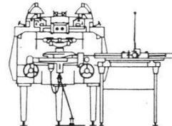
registriert acht Kennziffern, die Modellkoordinaten X Y auf 1/100 mm und Z mit Hundertstelmmillimeter Modellgenauigkeit direkt in Metern oder englischen Fuß
